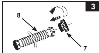
4. Соедините и привинтите конец шланга А (8) с адаптером к сетчатому фильтру с резьбой изнутри бассейна. См. рис. 4.
