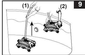
3. Возьмите водяной пылесос за основание двумя руками и медленно поднимите его под углом (на ваш выбор передней или задней частью кверху). См. рис.10. После того как воды в пылесосе не останется, возьмите пылесос двумя руками.
